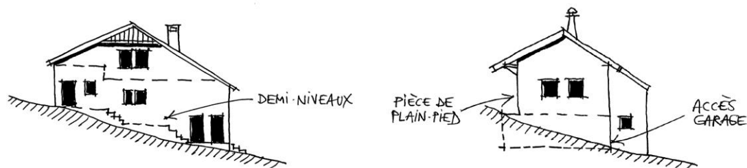
Exemples d'implantations conseillées : adaptation de la maison au relief naturel du terrain.
